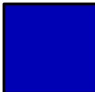
Im Vakuum wird in einem Plasmaprozess bei ca. 300 °C eine **transparente** ca. 75 nm (= 0,000075 mm) dicke Si<sub>3</sub>N<sub>4</sub> - Schicht aufgebracht, **diese Schicht ist durchsichtig, wir sehen aber blau- schwarz**, sie verhindert die Reflexion des einfallenden Lichts an der Si-Oberfläche, d.h. es taucht möglichst viel Licht in den Si-Wafer ein. Die sichtbare dunkelblaue Farbe ist ein optischer Effekt: siehe „Farben dünner Plättchen“.
