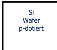
Siliziumscheibe, hochreines Si monokristallin oder polykristallin, Standardmaß 156,75 x 156,75 mm (6 Zoll) Dicke ca. 0,18 mm. In der PV- Industrie werden bereits größere Wafermaße bis 210 mm verwendet! p- Dotierung mit **Bor** (wird bereits in die Schmelze bei der Herstellung eingefügt).
