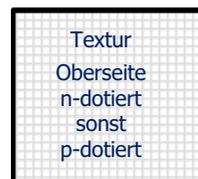
In einem Ofen strömt bei 900°C - 950°C Phosphoroxychlorid (POCl<sub>3</sub>) über die Oberfläche des Si- Wafers. Die [P]- Atome dringen in die Oberfläche **ca. 0,2 µm** tief ein. Dort bildet sich der **p-n-Übergang**, der für die Ladungstrennung in der Solarzelle wichtig ist.
